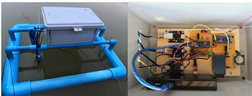
ภาพประกอบที่ 3.8 หุ่นอุปกรณ์ที่ใช้สำหรับเก็บข้อมูลจากเขื่อนลำปะทาวและส่วนประกอบอุปกรณ์เซนเซอร์สำหรับจัดเก็บข้อมูลคุณภาพน้ำ
